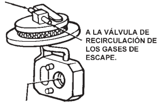
FIGURA 9. Válvula transductora de contrapresión de gases de escape
